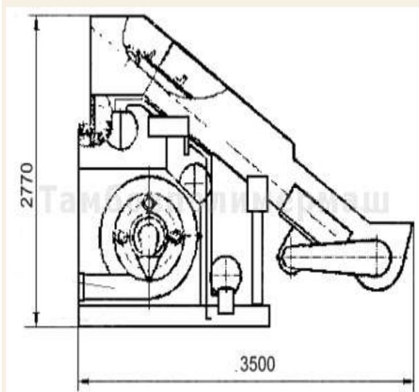
Предназначен для измельчения резиновых неармированных отходов в крошку размером 0,3 - 10 мм. Может работать самостоятельно или в составе линий на заводах РТИ и др. предприятиях.
