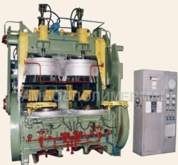
Предназначен для формования и вулканизации легковых покрышек радиальной конструкции в секторных пресс-формах. Представляет собой двухпозиционный кривошипно-шатунный пресс с электромеханическим приводом траверсы, оснащен загрузочным устройством, клиновыми секторными механизмами для размещения секторных пресс-форм и управления ими.
