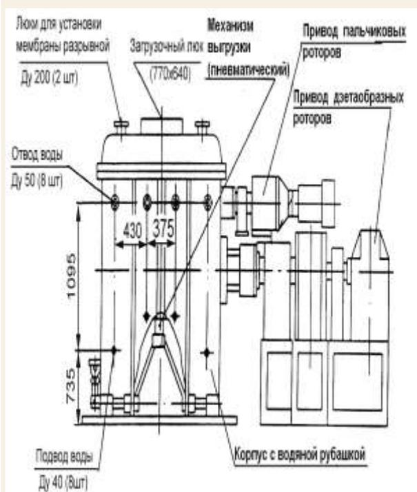
Предназначен для перемешивания резино-асбестовых смесей с помощью дзетаобразных роторов в корпусе с водяным охлаждением (в рубашке).
