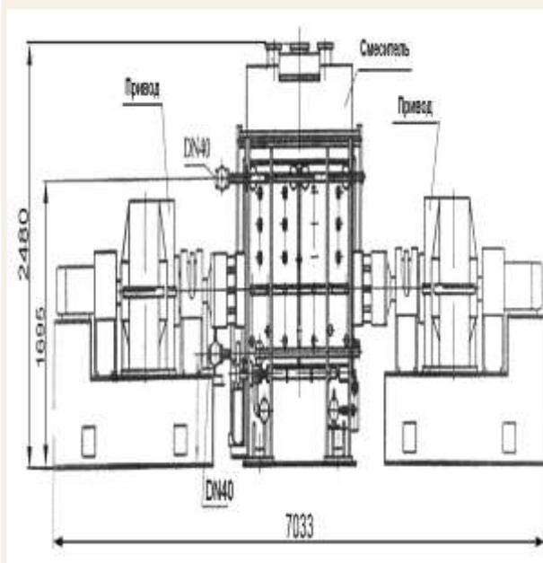
Предназначен для перемешивания электродной и анодной массы.
